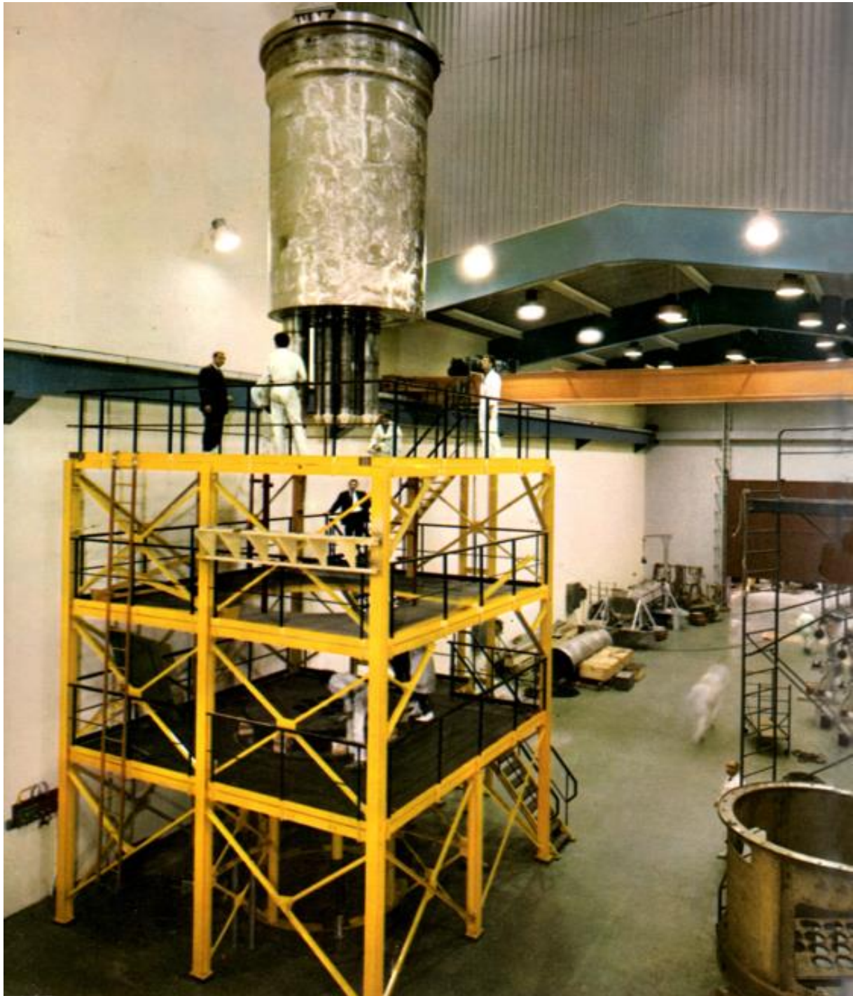
Montage d'un élément du réacteur « ESSOR » Photo : revues ou bulletins techniques Chantiers de l'Atlantique
