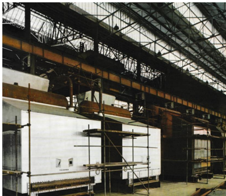
Nef de montage des chaudières Marine et des chaudières Package Photo : revues ou bulletins techniques Chantiers de l'Atlantique
