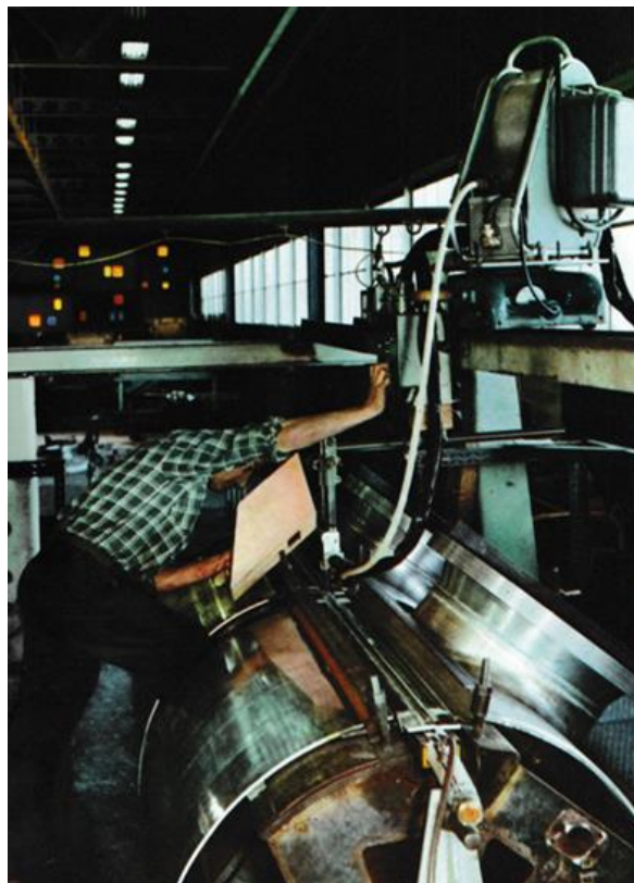
Poste de soudure longitudinal impliquant une qualité « nucléaire » et des épreuves d'étanchéité sous vide très poussées
