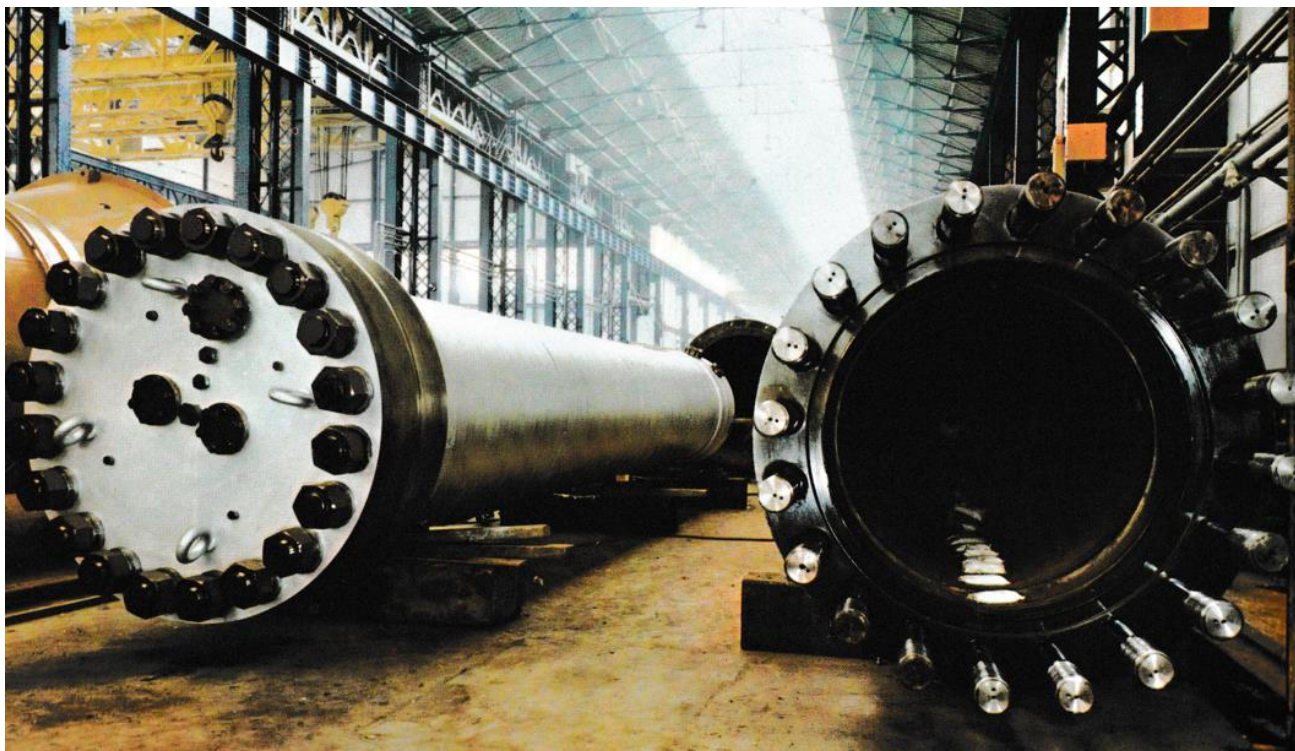
Tubes de synthèse d'ammoniac Diamètre 1,40 m, épaisseur 114 mm, longueur 12 m, poids 77 t Photo : revues ou bulletins techniques Chantiers de l'Atlantique
