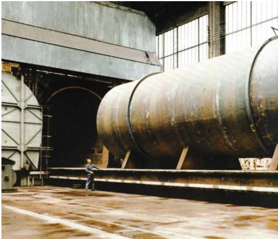
Four pour recuit Ø 5,5 m, longueur : 25 m, poids : 250 t
