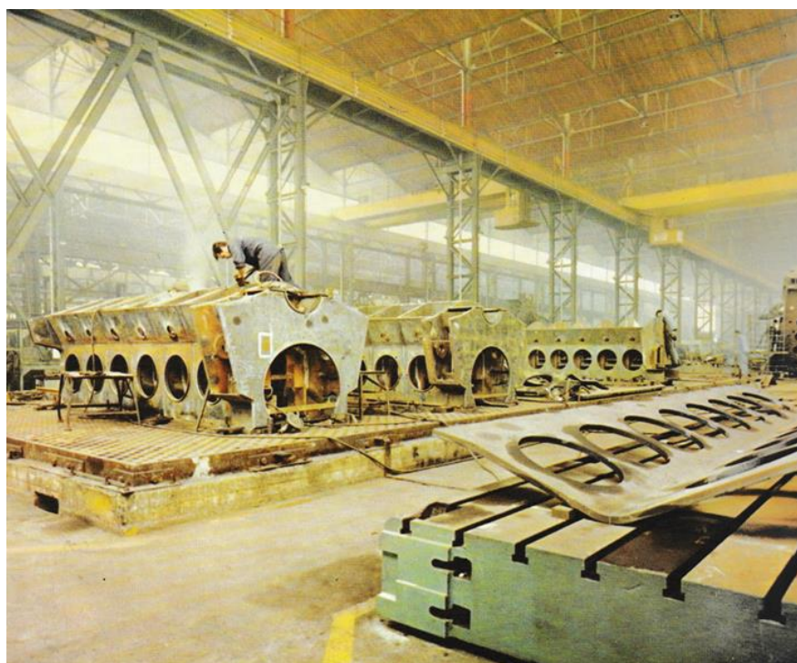
Vue d'ensemble de la section des bâtis mécano-soudés moteurs Diesel PC Photo : revues ou bulletins techniques Chantiers de l'Atlantique
