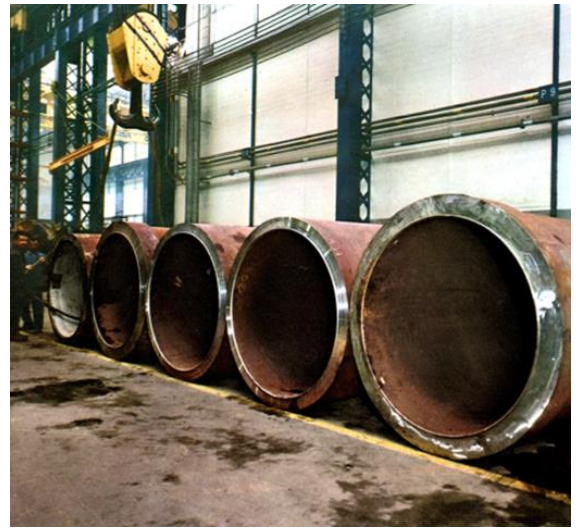
Viroles Multiwall, chanfreinées avant assemblage et soudure
