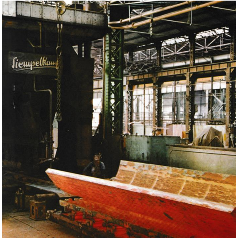
Presse de 4000-5000 tonnes « Siempelkamp » pour le cintrage des viroles jusqu'à 200 mm d'épaisseur Photo : revues ou bulletins techniques Chantiers de l'Atlantique
