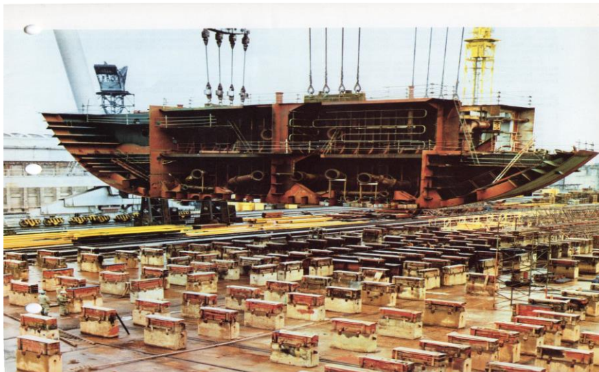
Attinage dans la cale de construction des navires
