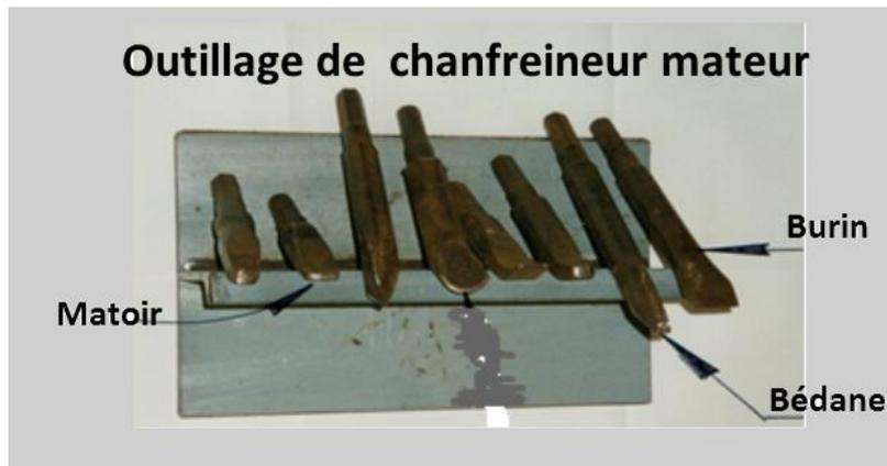
Le métier de « Chanfreineur- mateur » d'épreuves de capacités, consiste à rendre parfaitement étanches les capacités du navire susceptibles de contenir de l'eau douce, de l'eau salée, de l'huile ou du fuel combustible sous le contrôle du représentant armateur.
